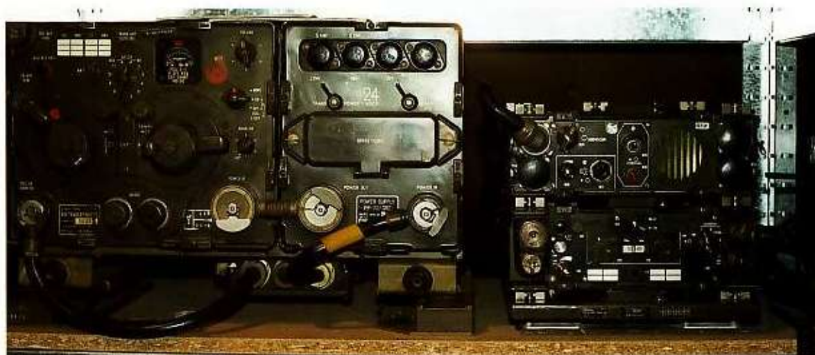
De RT66 met voeding PP112, rechts staat de RT3600 op een mounting
